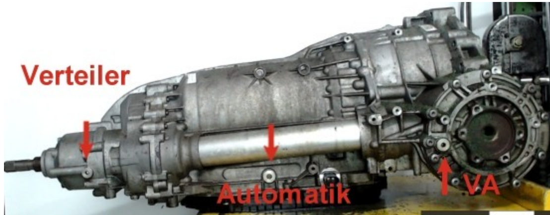
Kontrollschrauben ( am Beispiel 8HP65)
